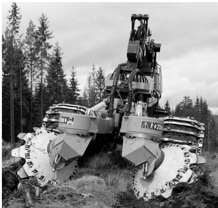
Рис. 2. Форвардер агрегированный с двухрядным дисковым культиватором
